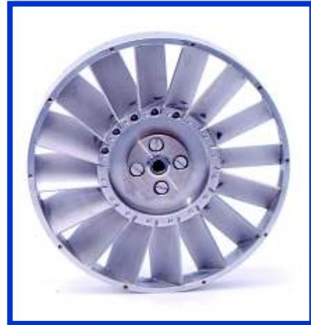
Вращательное движение турбины отслеживается магнитно-индуктивным датчиком, вмонтированным в наружную стенку корпуса расходомера. Датчик не имеет контакта с измерительной средой и не влияет на поток жидкости. Измерительная головка датчика представляет собой катушку индуктивности, в которой возбуждается электромагнитное поле.
